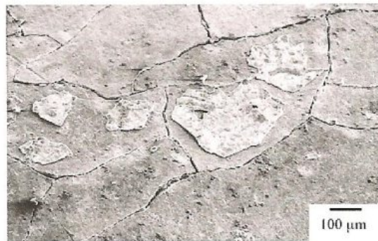
Figura 4 – Superfície típica de aço AISI H13 com trincas após 10.000 ciclos a 700°C em argônio (Persson et al, 2005).
