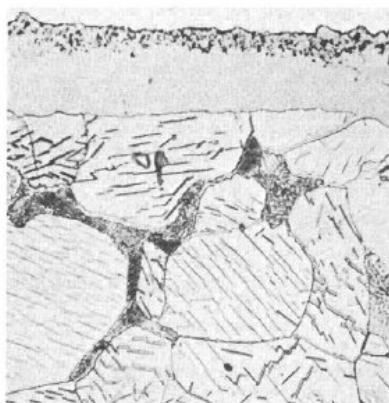
Figura 18 - Microestrutura do aço AISI 1015 – nitretação líquida (ASM HANDBOOK, 1991)
