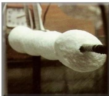
Figura 4 – Cabo com perfil assimétrico por acúmulo de gelo.
