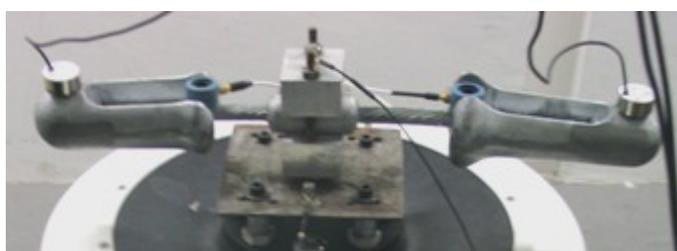
Figura 51 – Fixação do Stockbridge no Shaker com garra serrada.
