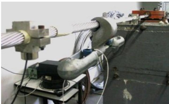
Figura 31 – Montagem do Stockbridge no vão experimental
