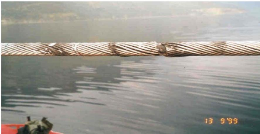
Figura 12 – Falha Típica por Fadiga em Sinalizador para Aviação.
