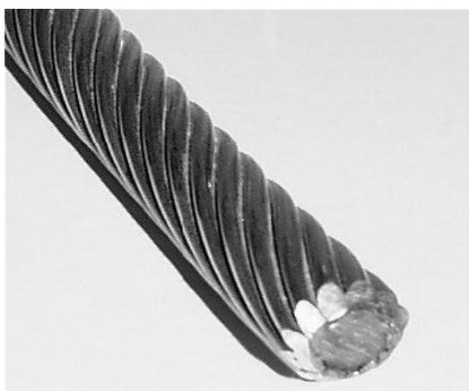
Figura 2 – Cabo mensageiro do amortecedor *Stockbridge*
