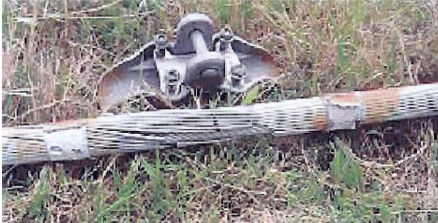
Figura 11 – Falha Típica por Fadiga em Suporte do Amortecedor.
