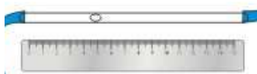
Figura 2 - Componentes para leitura do deslocamento do líquido (capilar de vidro e escala em milímetros).
