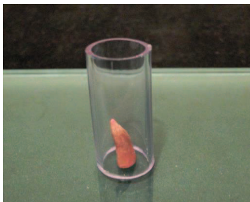
Figura 5 - Molde de borracha fixado à placa de vidro, contendo espécime para inclusão em resina de poliéster.
