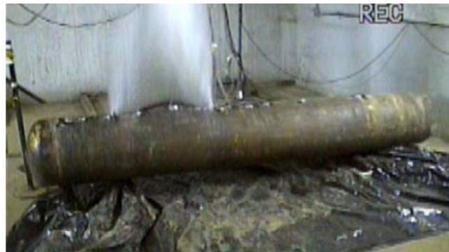
Figura 3.7 - Burst test de duto com defeito de corrosão longo. Fonte: Benjamim et al. (2004)
