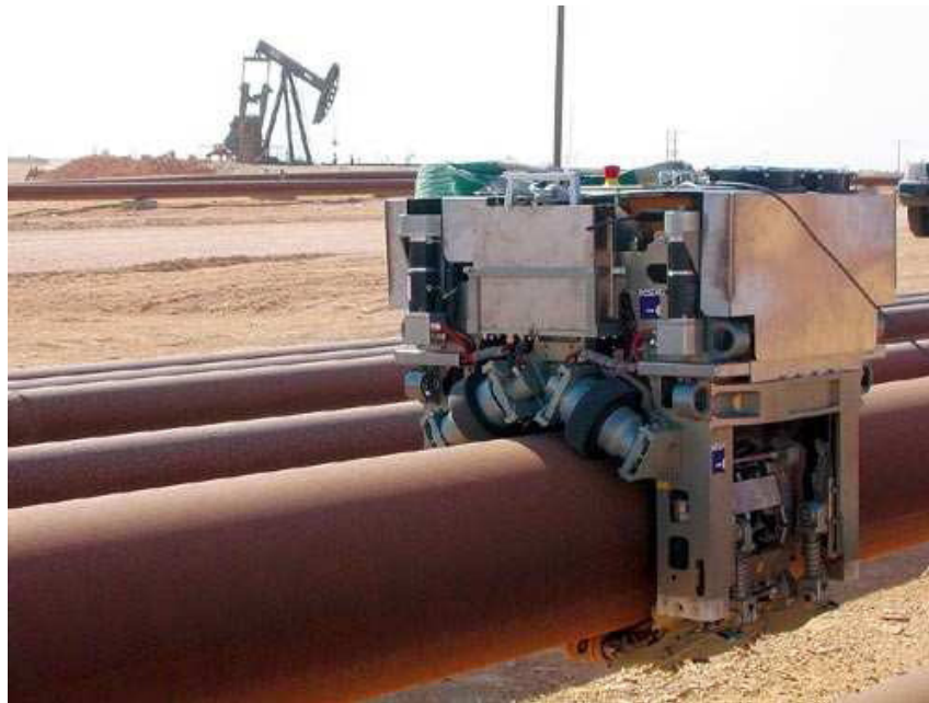
Figura 2.6 – Inspetor externo de dutos (IED). Fonte: Offshore technology (2006)
