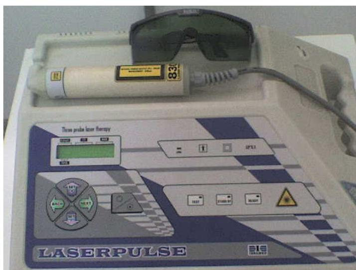
Figura 9: Aparelho LASERPULSE, caneta LASER comprimento de onda 830 nm, fabricado pela IBRAMED.
