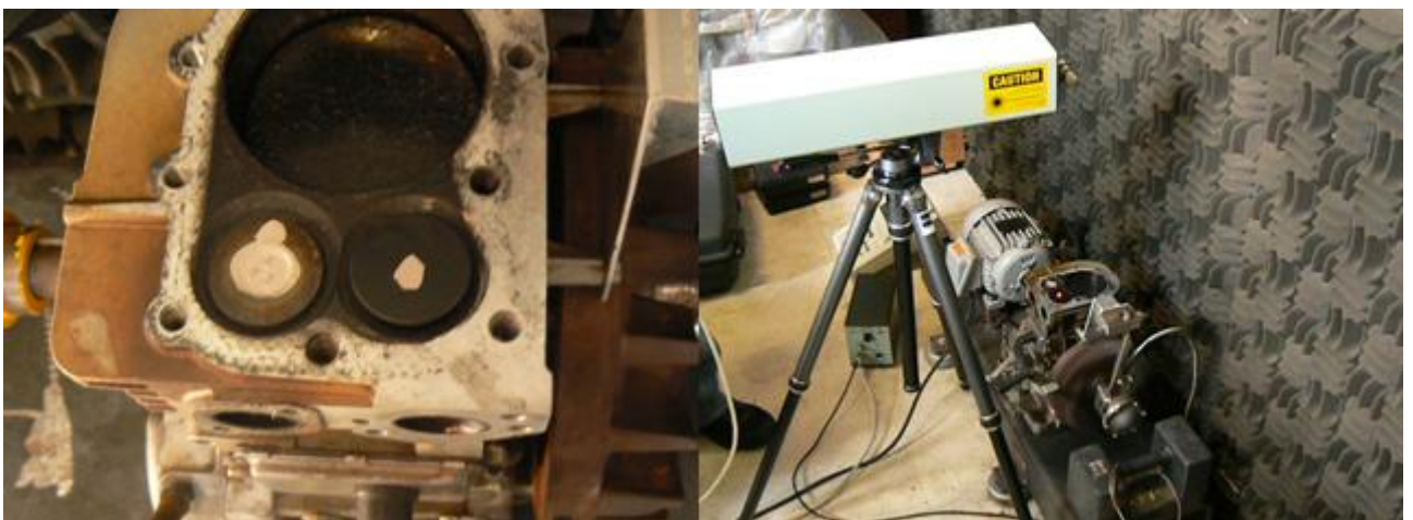
Figura 3.3: Medição da velocidade das válvulas.
