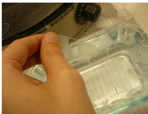
Figura 19: Procedimento de pescagem das fitas cortadas em micrótomo, colocadas em banho-maria para distensão.
