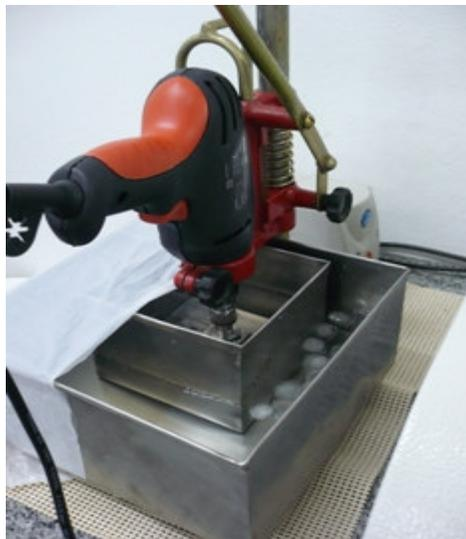
Figura 9: Dispositivo para a produção de partículas metálicas mostrando a furadeira elétrica adaptada em um suporte que permite o seu deslizamento, a cuba externa contendo água e gelo e a cuba interna contendo a solução onde as superfícies em atrito permaneceram imersas.
