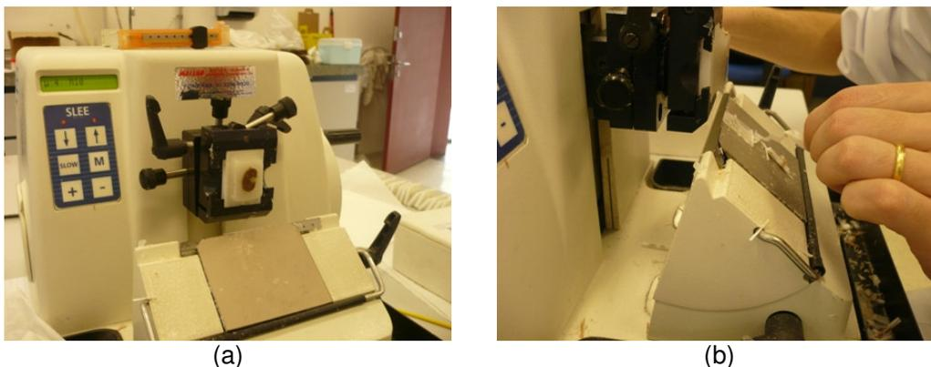
Figura 18: (a) Micrótomo com o bloco de parafina posicionado e (b) corte do bloco de parafina.
