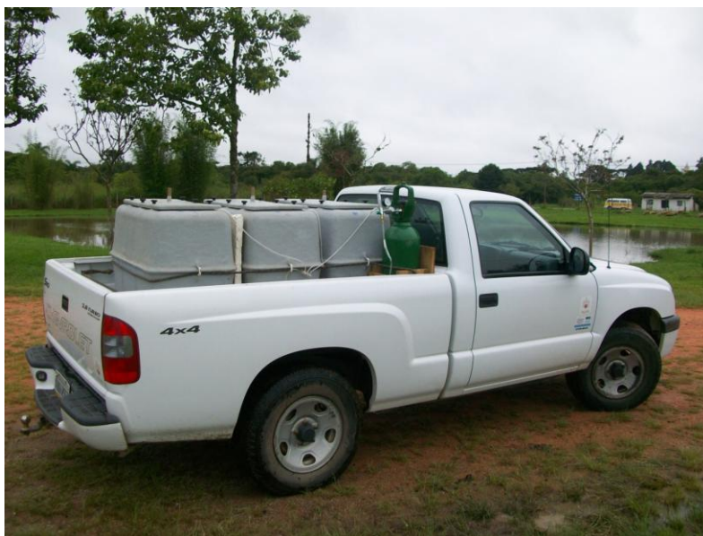
Figura 2: Caminhonete com as três unidades experimentais e sistema de injeção de oxigênio dissolvido.
