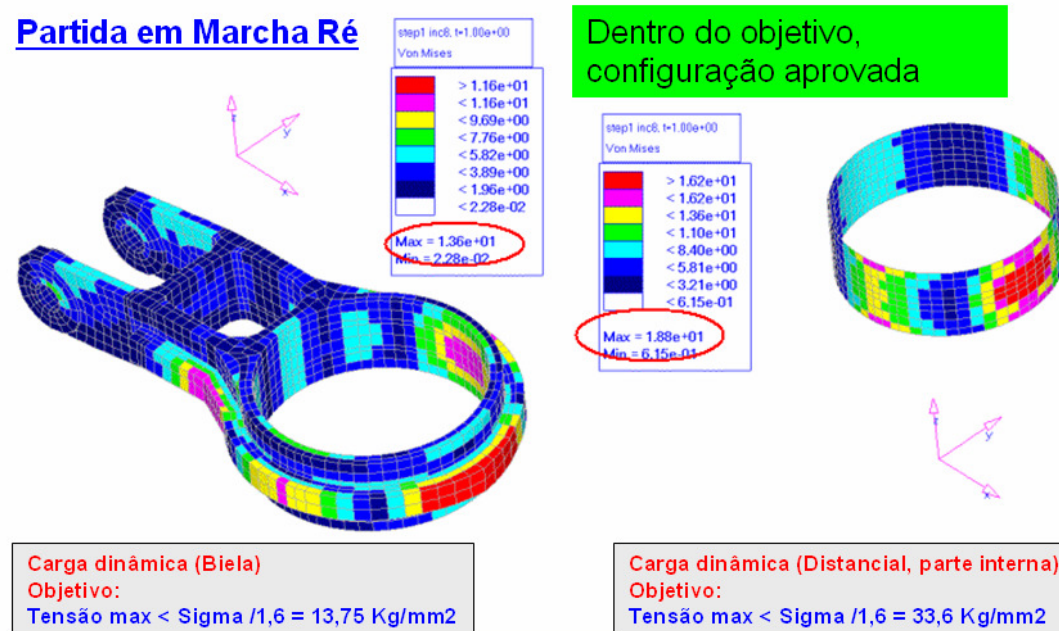
Figura 24: Versão aprovada em acordo com a distribuição correta de forças aplicadas sobre a biela.
