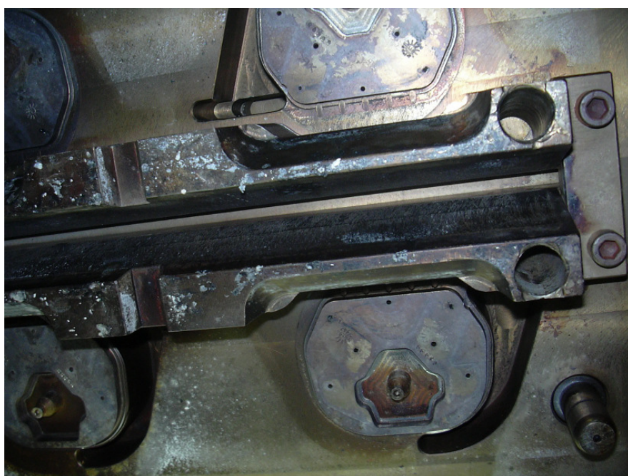
Figura 36 - Detalhe do molde de vulcanização: ajuste da carcaça na cavidade do molde
