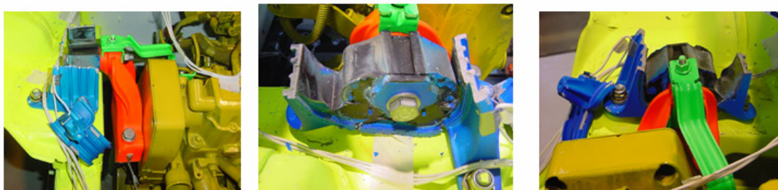
Figura 32: Evidência da quebra da carcaça do coxim lado motor em teste em banco
