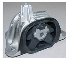
Figura 29c:Coxim vulcanizado Fonte: o autor
