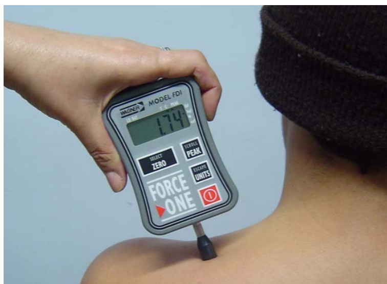
Figura 7 - Algômetro digital de pressão utilizado no trabalho. Modelo FDI, Fabricante Wagner Instruments.
