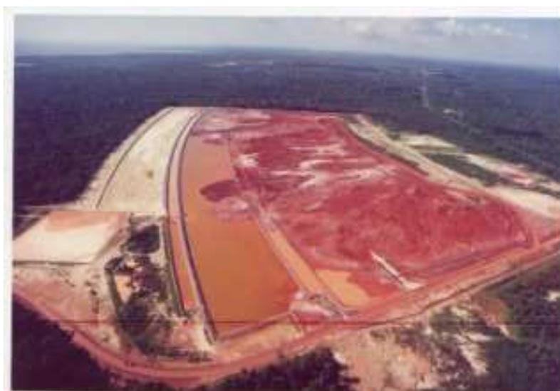
FIGURA 7 – Área de rejeito de lama vermelha.
