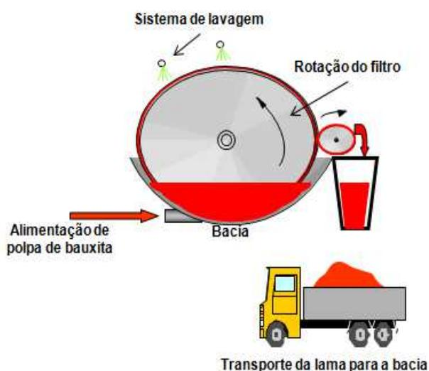
FIGURA 4 – Processo de lavagem da lama vermelha.
