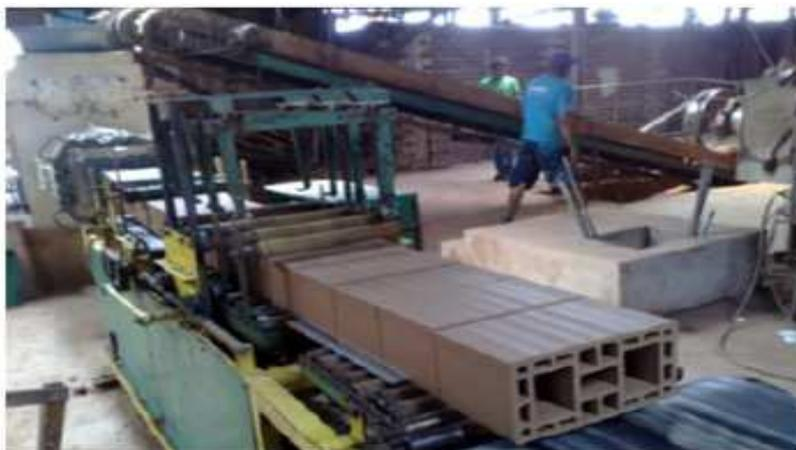
FIGURA 9 – Tijolos (Blocos) produzidos com a lama vermelha.
