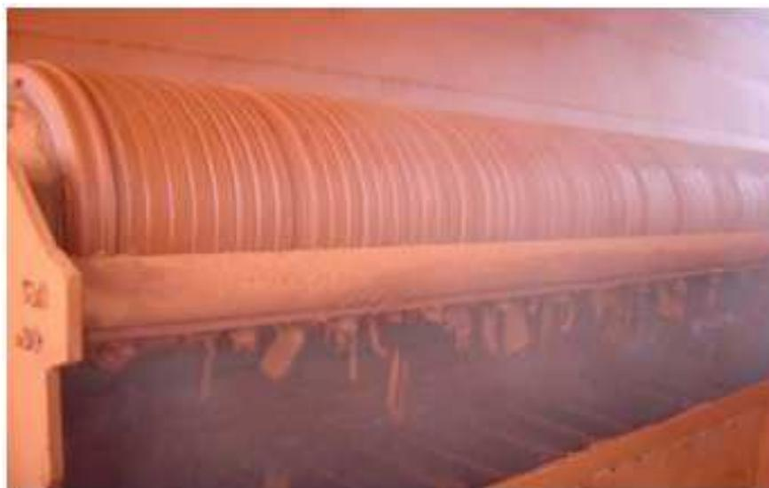
FIGURA 8 – Saída de lama vermelha após lavagem.
