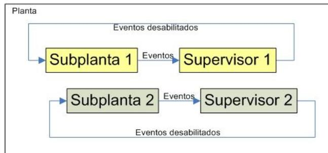
Figura 2.18 - Esquema de controle modular local
