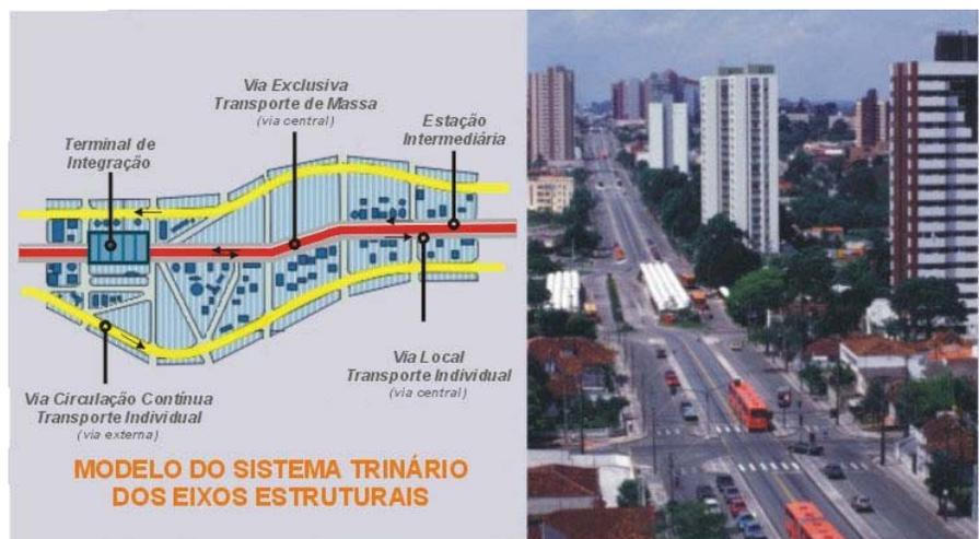
Modelo do Sistema Trinário dos Eixos Estruturais (Fonte: IPPUC, 2004)
