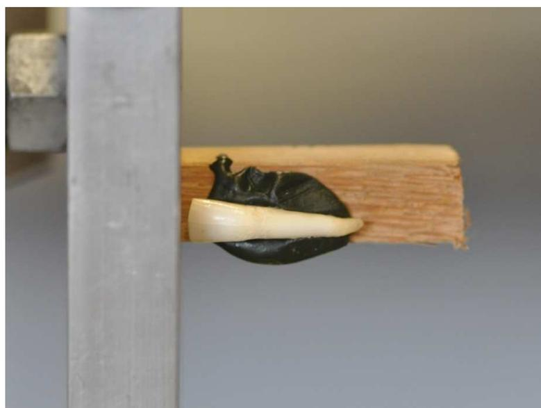
Figura 12 - Conjunto fixado na cortadora de precisão.
