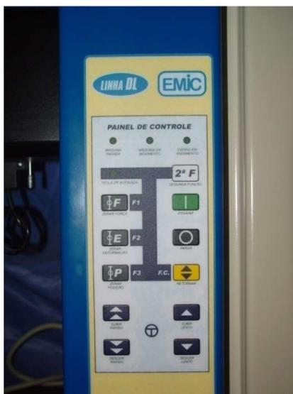
Figura 53 - Painel de controle da máquina de ensaios universais.
