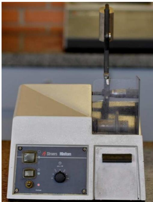
Figura 10 - Cortadora de precisão.
