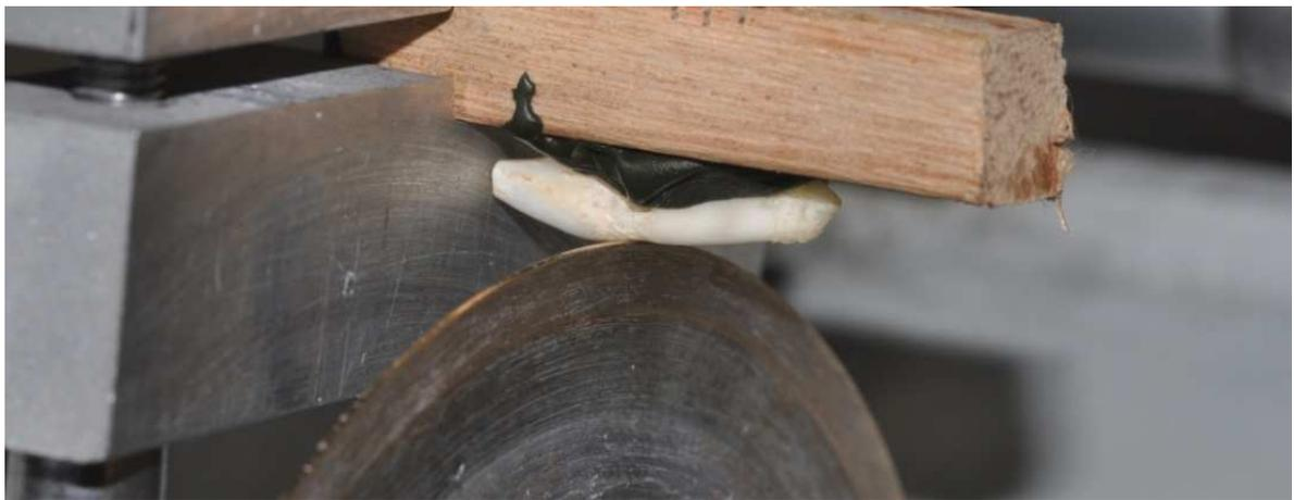
Figura 14 - Determinação do local do corte para remoção coronal (aproximadamente 12mm do ápice anatômico).
