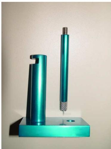
Figura 52 - Dispositivo desenvolvido para a realização dos ensaios mecânicos de resistência ao cisalhamento por extrusão – push out.
