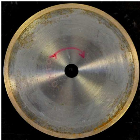
Figura 9 - Disco de corte diamantado.
