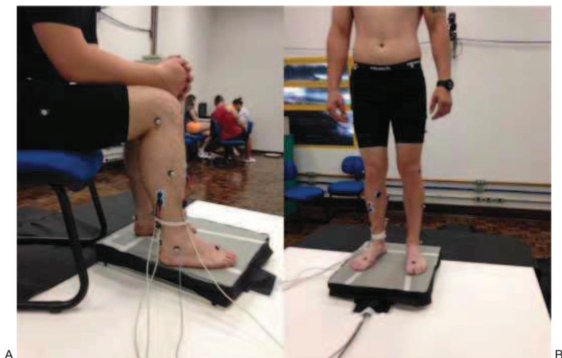
**Figura 11 - Representação do arranjo experimental, com a primeira posição de coleta (sentado e relaxado – A), ao lado o participante posicionado em pé (B) para realizar as outras três coletas do protocolo estabelecido: em pé sem perturbação, em pé com perturbação (movimento posteroanterior da base de suporte), e novamente em pé idêntico ao anterior.**
