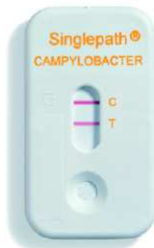
Figura 4 – Reação de imunocromatografia rápida positiva para Campylobacter observada pela linha vermelha formada ao lado da letra “T” indicativa da área de realização do teste.
