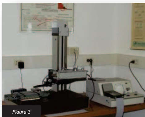
Figura 3 – Rugosímetro Taylor Hobson, para verificar as medidas iniciais e finais.
