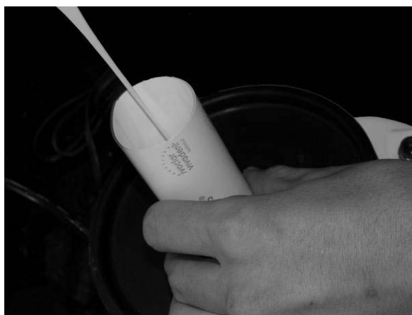
Fig 10 – Inclusão do revestimento no anel sobre vibrador.
