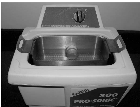
Fig 24 – Limpeza final em ácido fluorídrico 1%, 10 min em ultrasom
