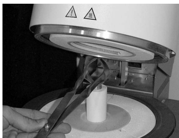
Fig 16 – Pastilha sendo depositada dentro do anel.
