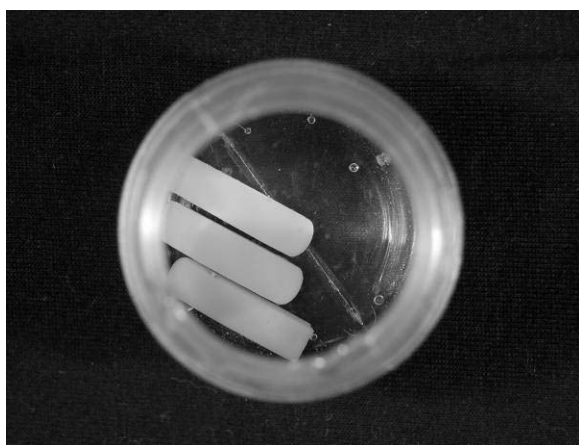
Fig 23 – Limpeza final em ácido fluorídrico 1%, 10 min em ultrasom.
