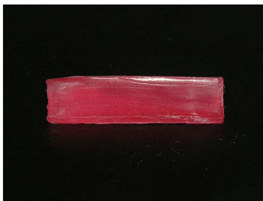
Fig 1: Padrão em cera 7 com 20 mm de comprimento, 5 mm de largura e 2 mm de espessura.
