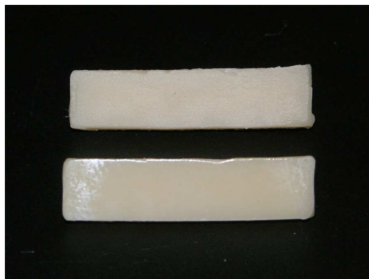
Fig 2: Espécimes em vitrocerâmicas. 30 polidas e 30 não polidas.
