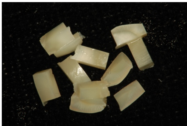
Fig. 9 – Alguns blocos de esmalte obtidos, com dimensões aproximadas de 2,5 mm x 2,5 mm x 1,0 mm.
