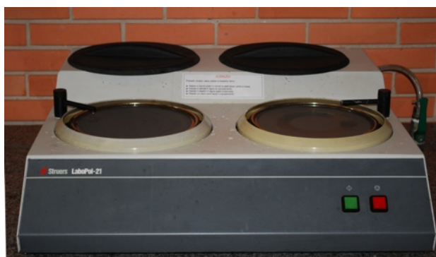
Fig. 2 – Polidora automática com refrigeração à água (Labopol-21/ Panambra Struers, Copenhagen, Dinamarca)
