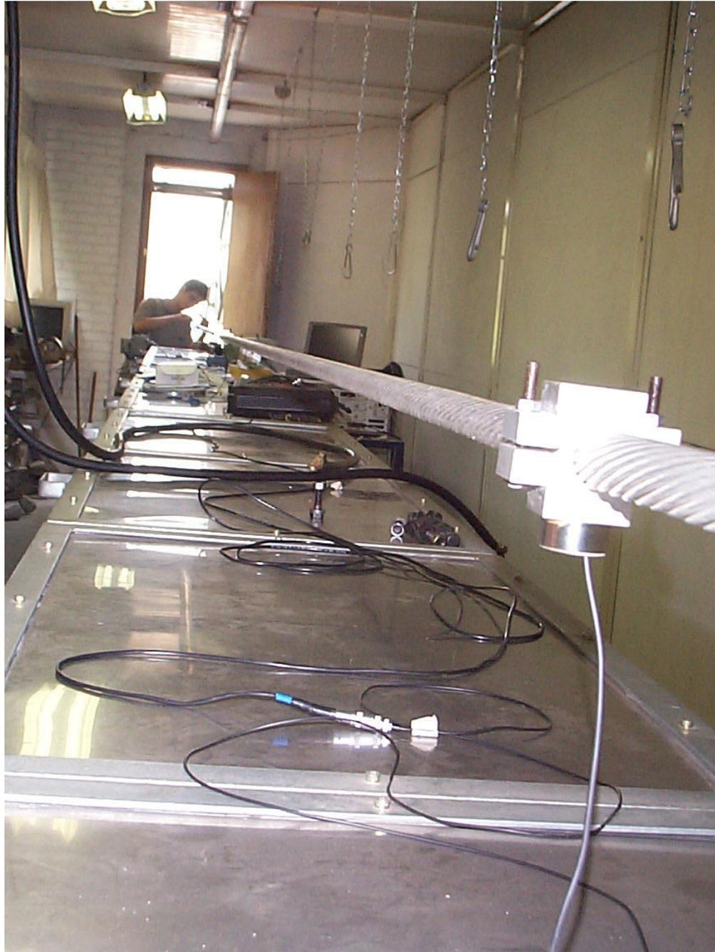
Figura (3.3.1) - Bancada para ensaios automatizados de cabos condutores.
