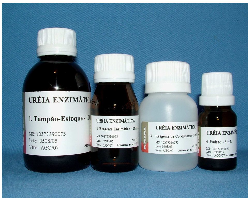
Fig. 6: Kit usado para quantificação da uréia salivar.
