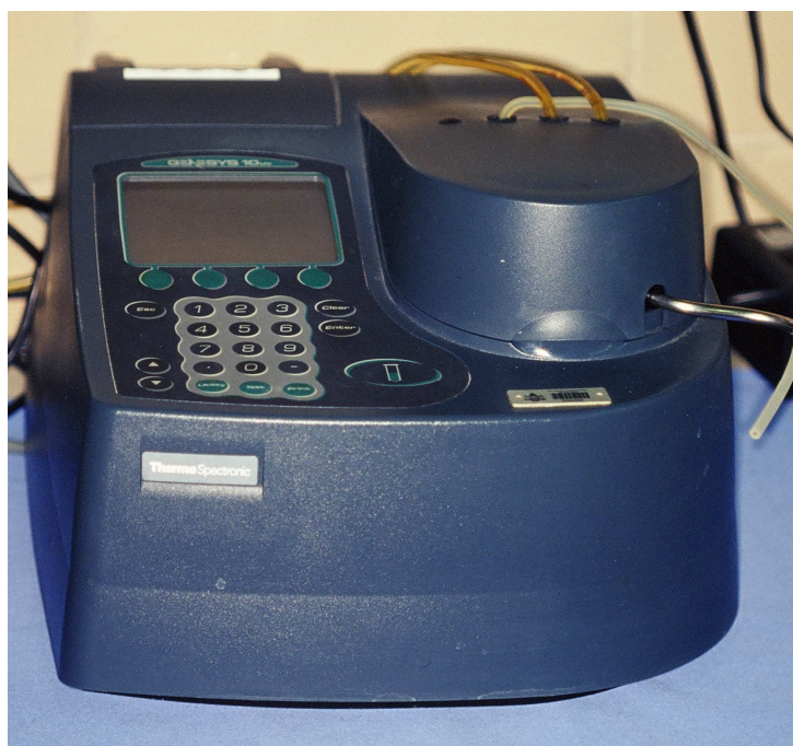
Fig. 4: Espectrofotômetro utilizado para leitura das absorvâncias.
