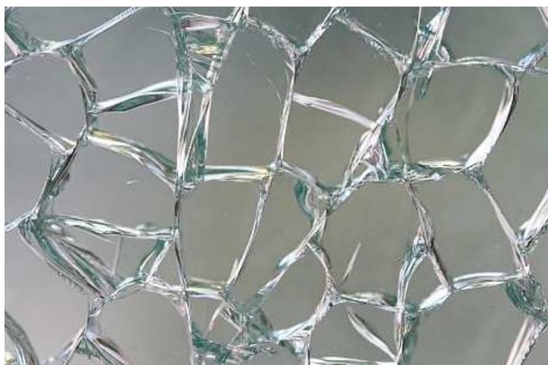
*Figura 06 – Vidro Temperado Quebrado.
