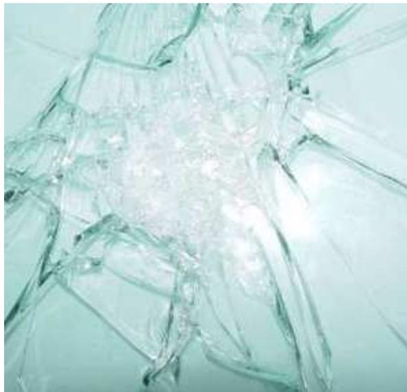
*Figura 07 – Vidro Laminado Quebrado.*
