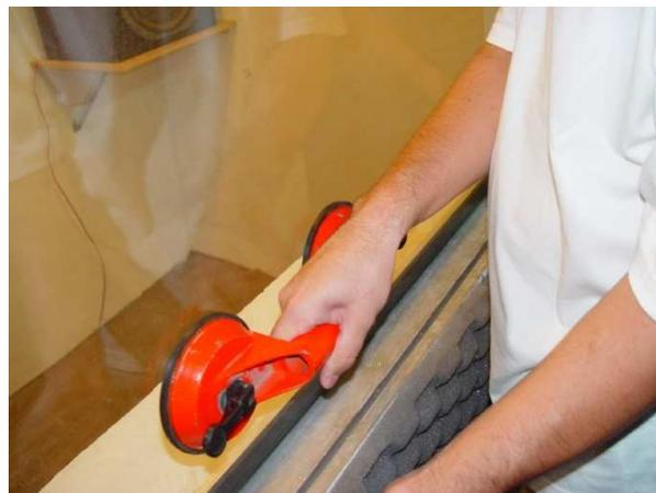
*Figura 36 – Ventosas para Auxiliar o Transporte dos Vidros.
