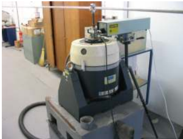
Figura 2.13 - Vista do Excitador Eletromagnético(modelo V100 ) acoplado ao cabo e do medidor de velocidade a Laser e célula de carga da excitação
