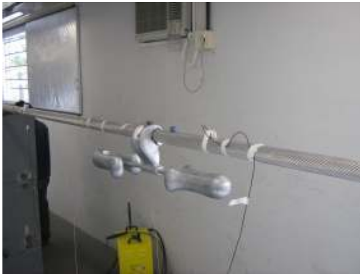
Figura 5.69 – Amortecedor assimétrico com os sensores de vibração instalados
