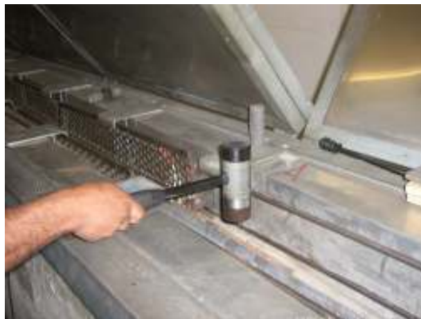
Figura 3.3 – Excitação com martelo de impacto no vão 13 metros
