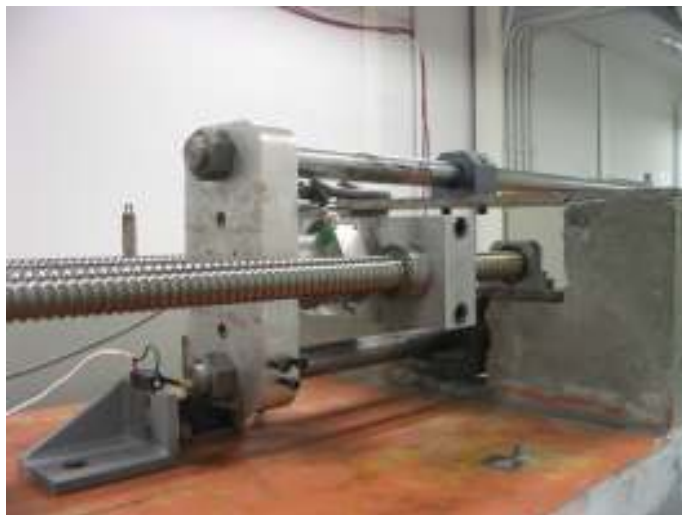
Figura 2.10 - Sistema de Tração com Fusos de Esferas Recirculantes
