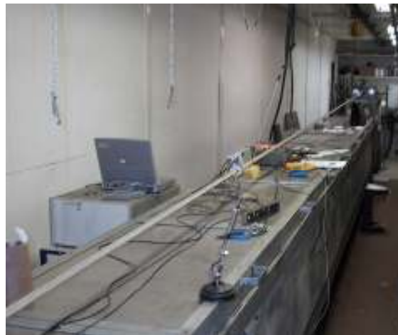
Figura 3.17 – Início do vão de 30 metros(acelerômetros e analisador de vibrações)
