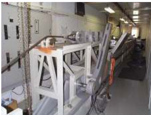
Figura 2.4 - Conjunto de Tração para Extensão da Bancada de Ensaios Mecânicos
