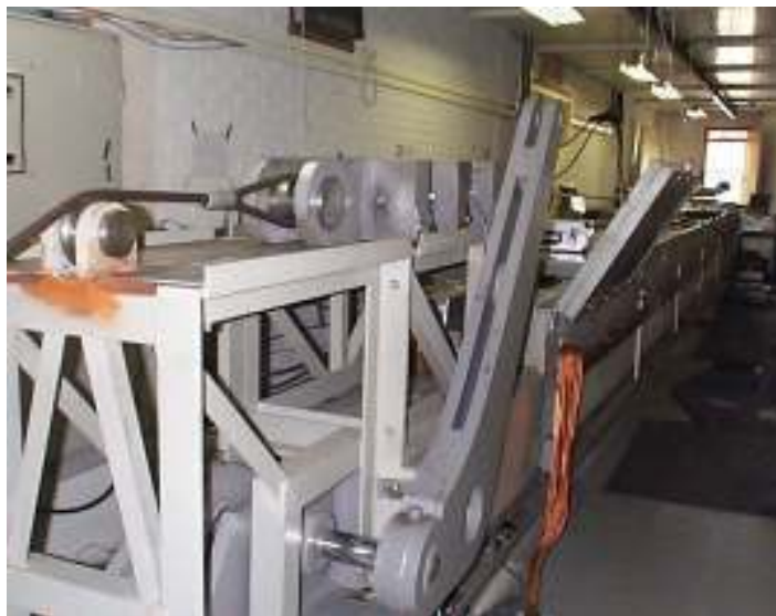
Figura 3.22 – Sistema Tração da Bancada com vão estendido para 65 metros
