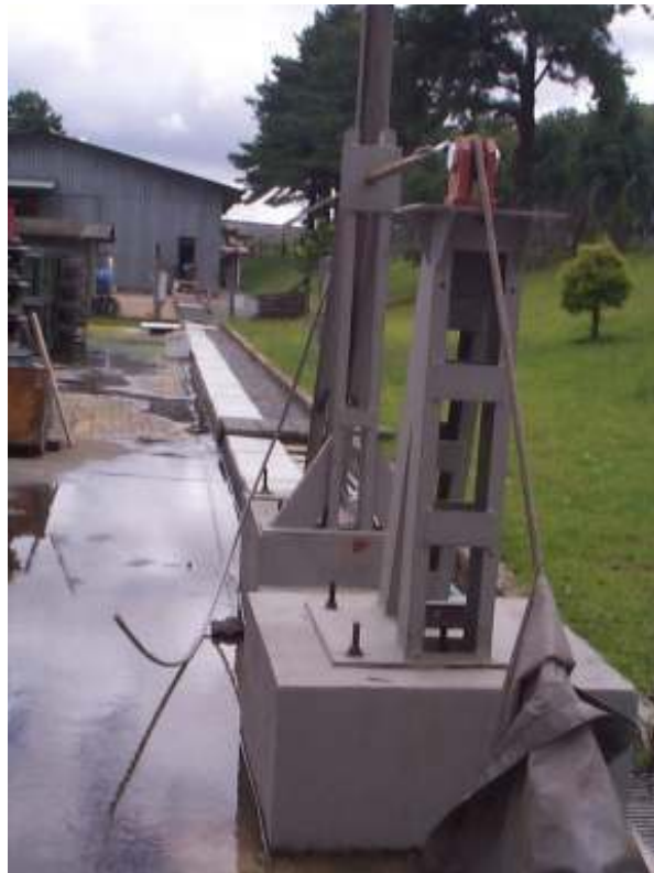
Figura 2.6 – Ancoragem Estendida da Bancada de Ensaios Mecânicos
