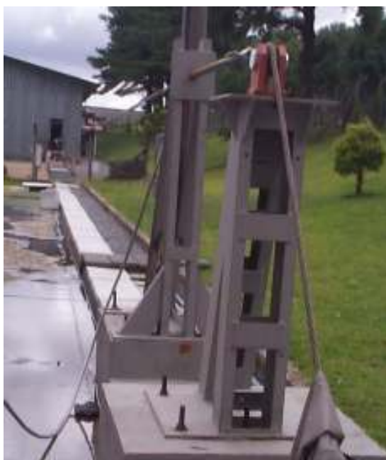
Figura 3.23 – Ancoragem para vão estendido de 65 metros
