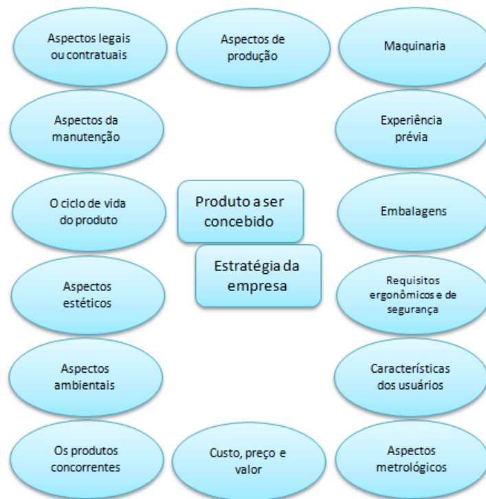
Figura 1 – Variáveis a serem consideradas na concepção de um produto. Fonte: Barbosa Filho (2009)
