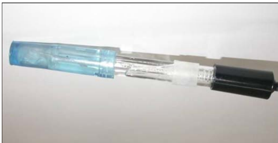
Figura 20 - Eletrodo combinado evidenciando a ausência de identificações.
