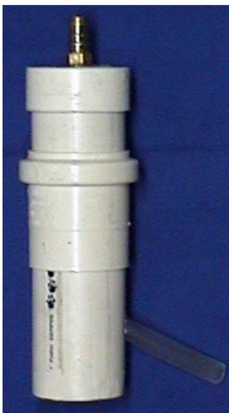
Figura 15 - Reservatório de água do manômetro
