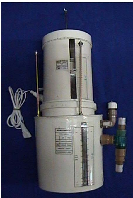
Figura 12 - Fole acoplado ao Cilindro Principal
