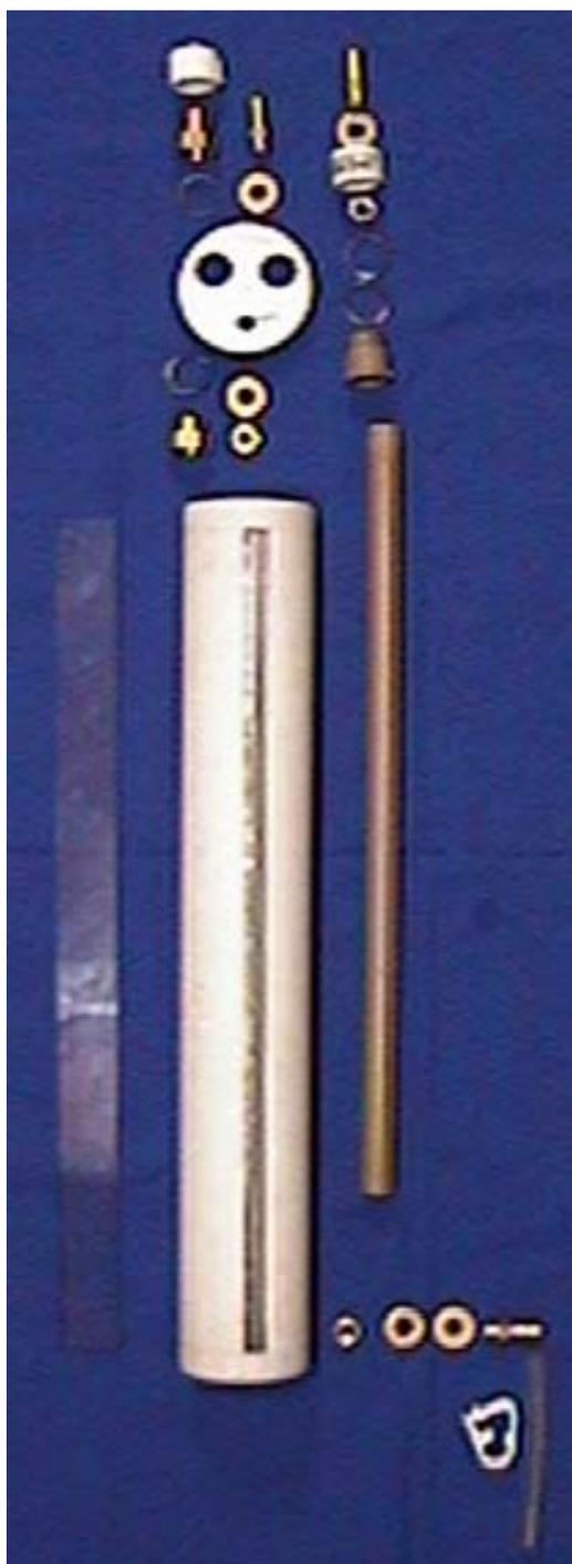
Figura 5 - Válvula de Segurança desmontada
