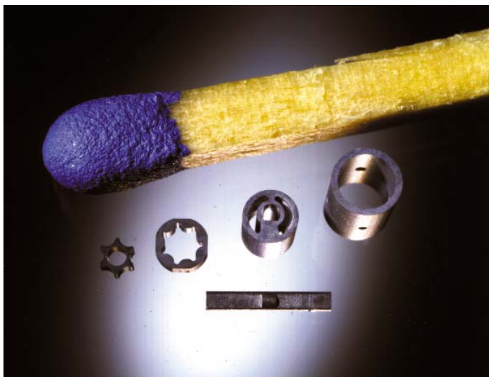
Figura 1: Peças de pequenas dimensões fabricadas por EDM (CHARMILLES, 2006).
