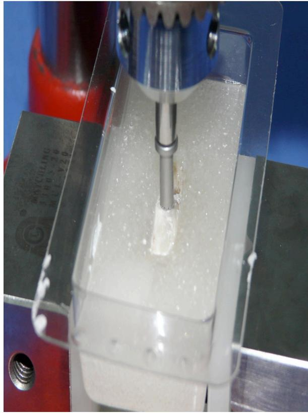
Figura 7 – Peça da tíbia removida e fixada em acrílico para teste mecânico de contratorque
