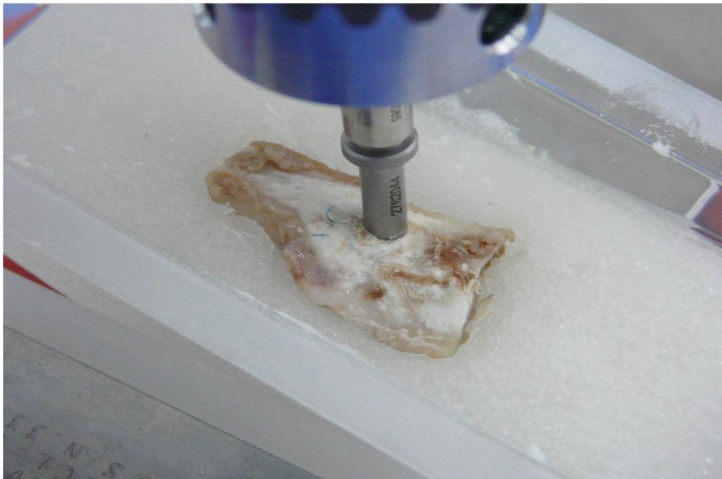
Figura 8 – Vista aproximada de conexão do torquímetro ao implante Titamax CM, no momento do teste de contratorque
