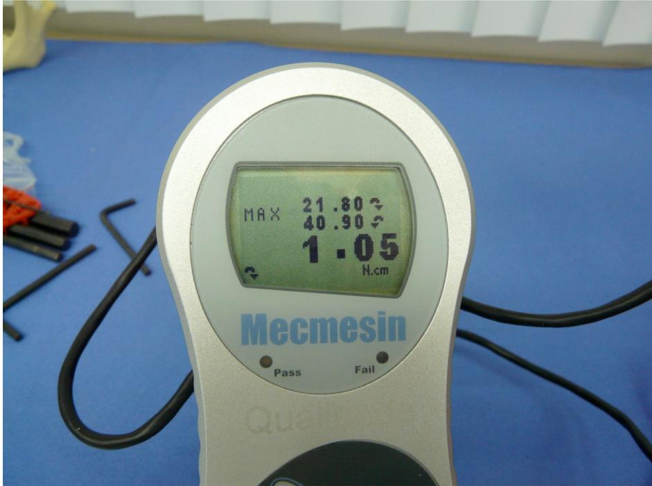
Figura 9 – Leitura do torquímetro digital para o experimento de contratorque
