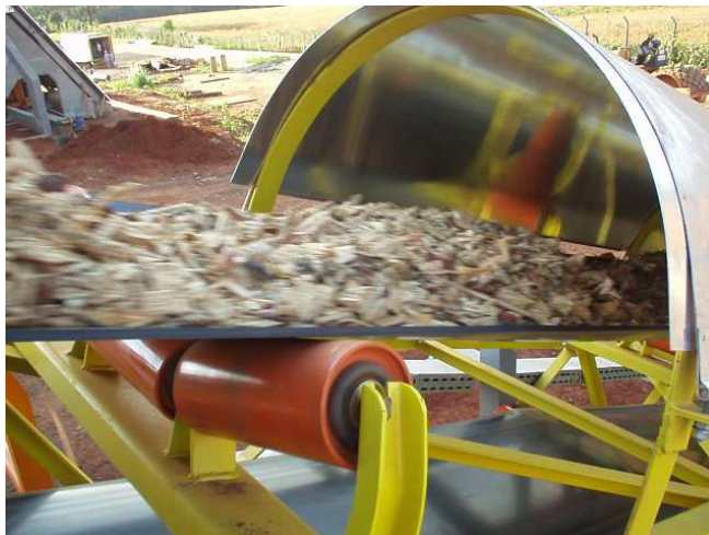
Figura 5.17 – Componentes de um transportador de correia.
