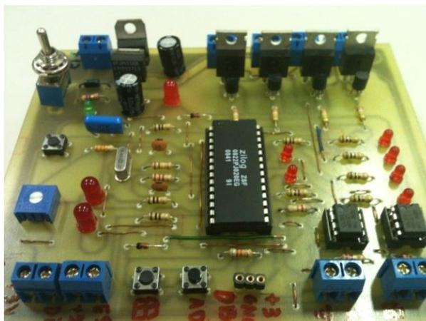
Figura 10 – Circuito Eletrônico que Executa o Posicionamento do Damper.
