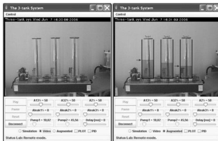
Figura 7 - Interface do usuário de um sistema de três tanques em modo remoto. Fonte: Duro et al. (2008).
