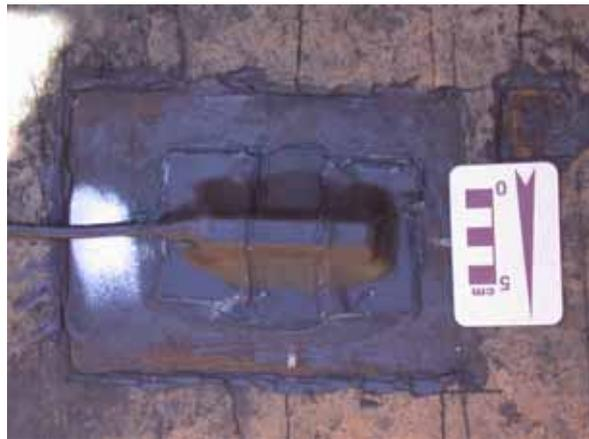
**Figura 2.10** – Duto instrumentado com extensômetro.
