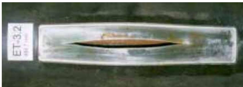
**Figura 3.5** - Detalhe de duto com defeito de corrosão longo após a ruptura.
