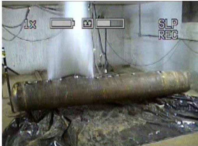
**Figura 3.4** - *Burst test* de duto com defeito de corrosão longo.
