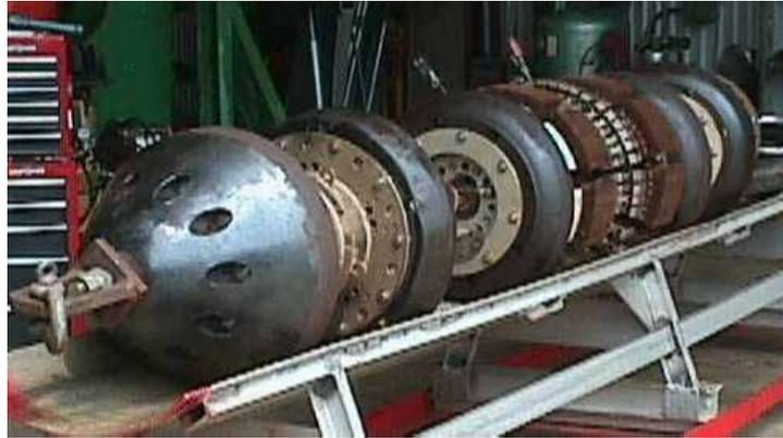
**Figura 2.9** – *PIG* de fluxo magnético.
