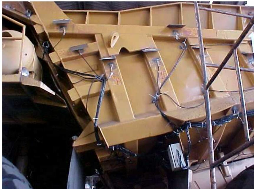
Figura 2.18- Extensômetros instalados na parede lateral com os dispositivos de proteção.
