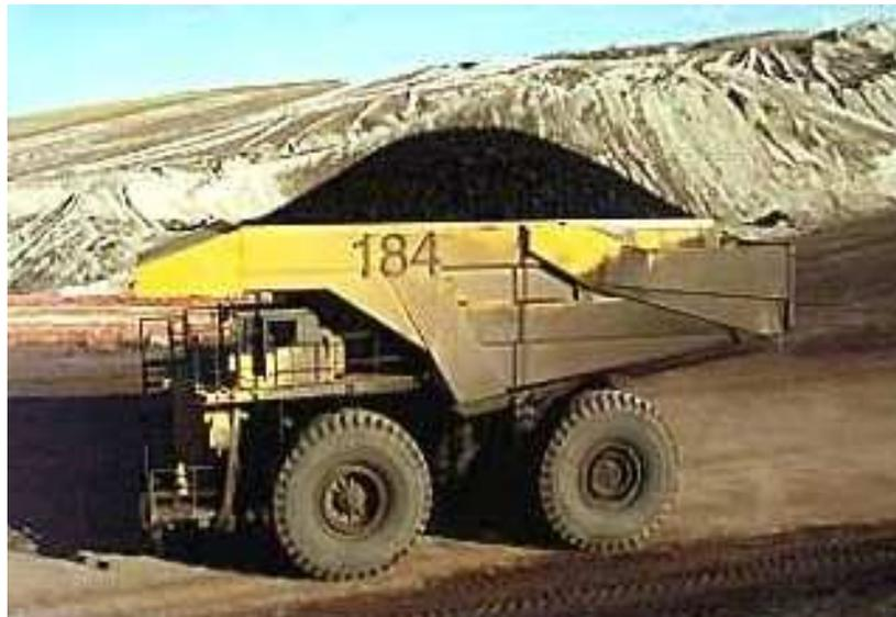
Figura 2.8 - Caçamba para carvão PHIL HIVOL® num Komatsu 930E. É a maior caçamba existente para caminhão fora-de-estrada, com volume de 430yd<sup>3</sup> (328,7m<sup>3</sup>), e 317 ton de capacidade.
