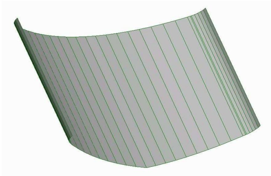
Figura 4.11 – Vista em perspectiva do Perfil 2; raio = 5.510mm; raio de concordância = 330,6mm.
