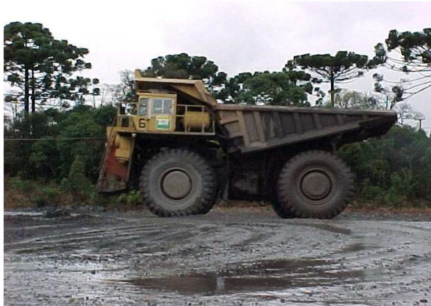
Figura 2.12 - Caminhão Haulpak 120 com caçamba original.
