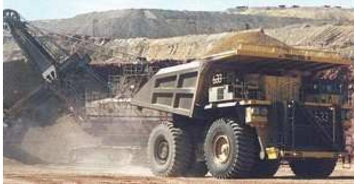
Figura 2.5 - Caminhão Catterpillar equipado com caçamba Trinity.
