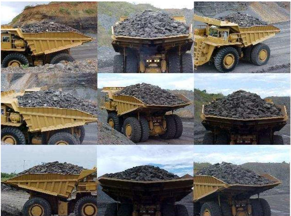
Figura 2.21 - Vistas diversas do caminhão com capacidade de 100 ton com carga normal
