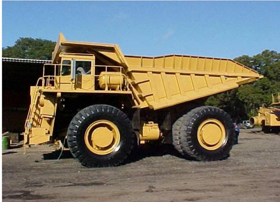
Figura 2.15 - Caminhão Haulpak 120 equipado com caçamba ampliada (terceiro projeto).
