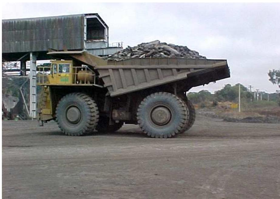
Figura 2.13 - Caminhão Haulpak 120 equipado com a primeira caçamba ampliada.
