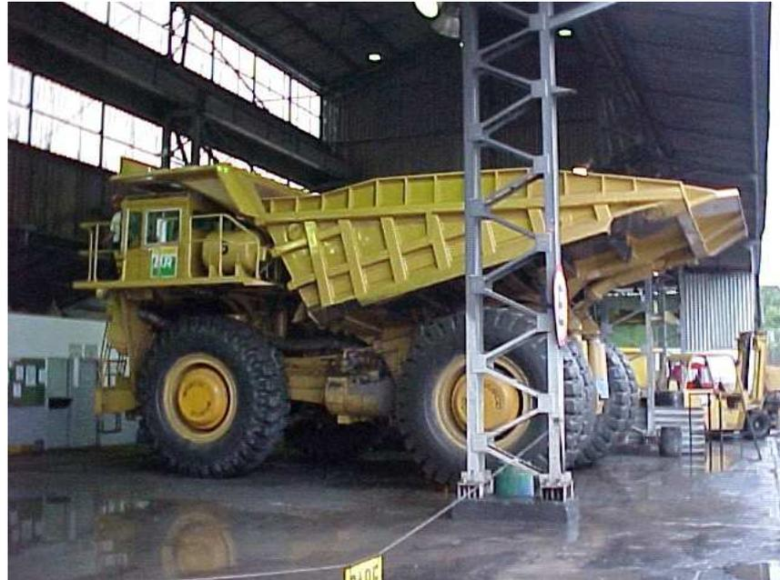
Figura 2.14 - Caminhão Haulpak 120 equipado com caçamba ampliada (segundo projeto).
