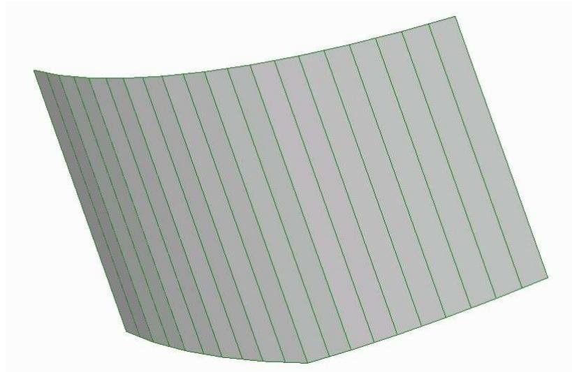
Figura 4.9 – Vista em perspectiva do Perfil 1; raio = 5.510mm.
