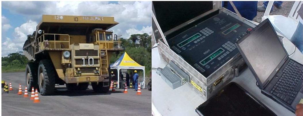
Figura 3.1 – Pesagem de caminhão Haulpak 120.
