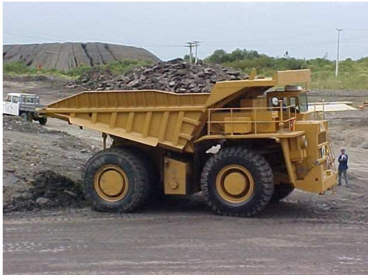
Figura 3.3 - Haulpak 120 carregado com a carga utilizada para avaliação da densidade do xisto.
