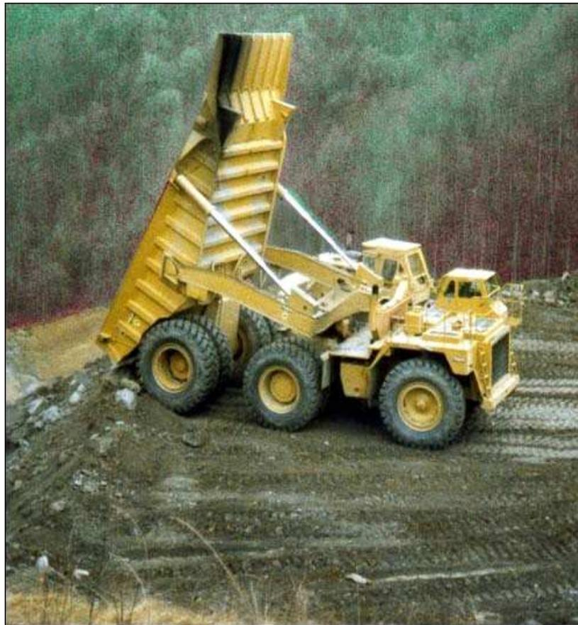
Figura 2.9 - Trailer com descarga traseira da Atlas-Maxter.
