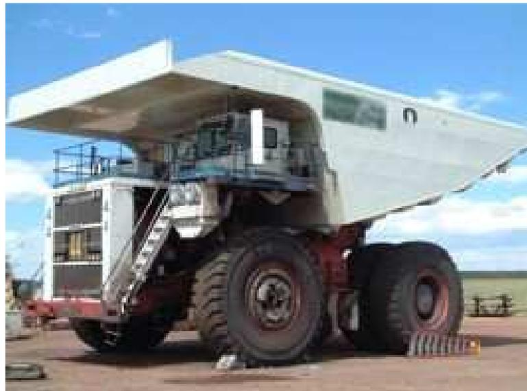
Figura 2.3 - Komatsu 930E equipado com caçamba Westech.
