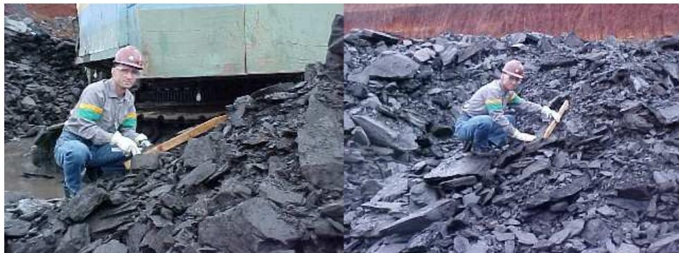
Figura 2.23 - Medição do ângulo de repouso do xisto desmontado.
