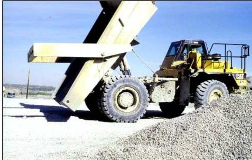
Figura 2.10 - Tailgate<sup>2</sup> automático da Atlas-Maxter.
