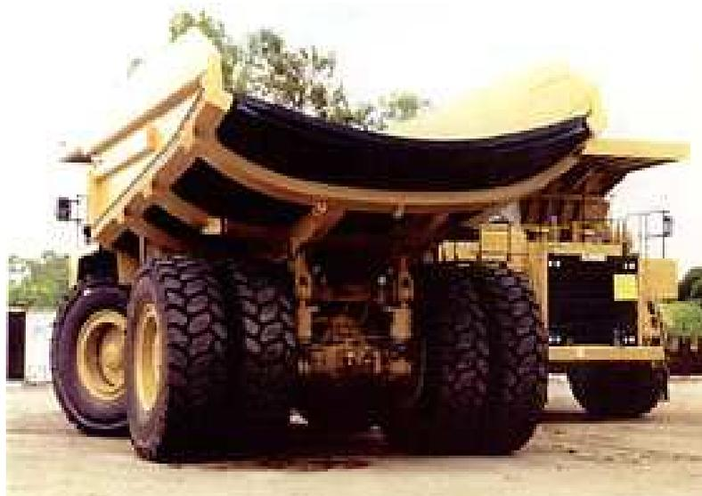
Figura 2.2 - CAT 785B, equipado com caçamba Duratray, transportando material úmido e aderente, em Lihir Gold Mine, Papua, Nova Guiné.
