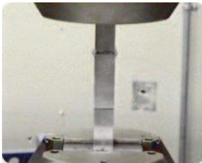
**Figura 1.1 – Chapas unidas por cola adesiva, sendo submetidas a um ensaio de tração. (FONTE: <http://www.bluer.com/applications/adhesive> [2010])**
