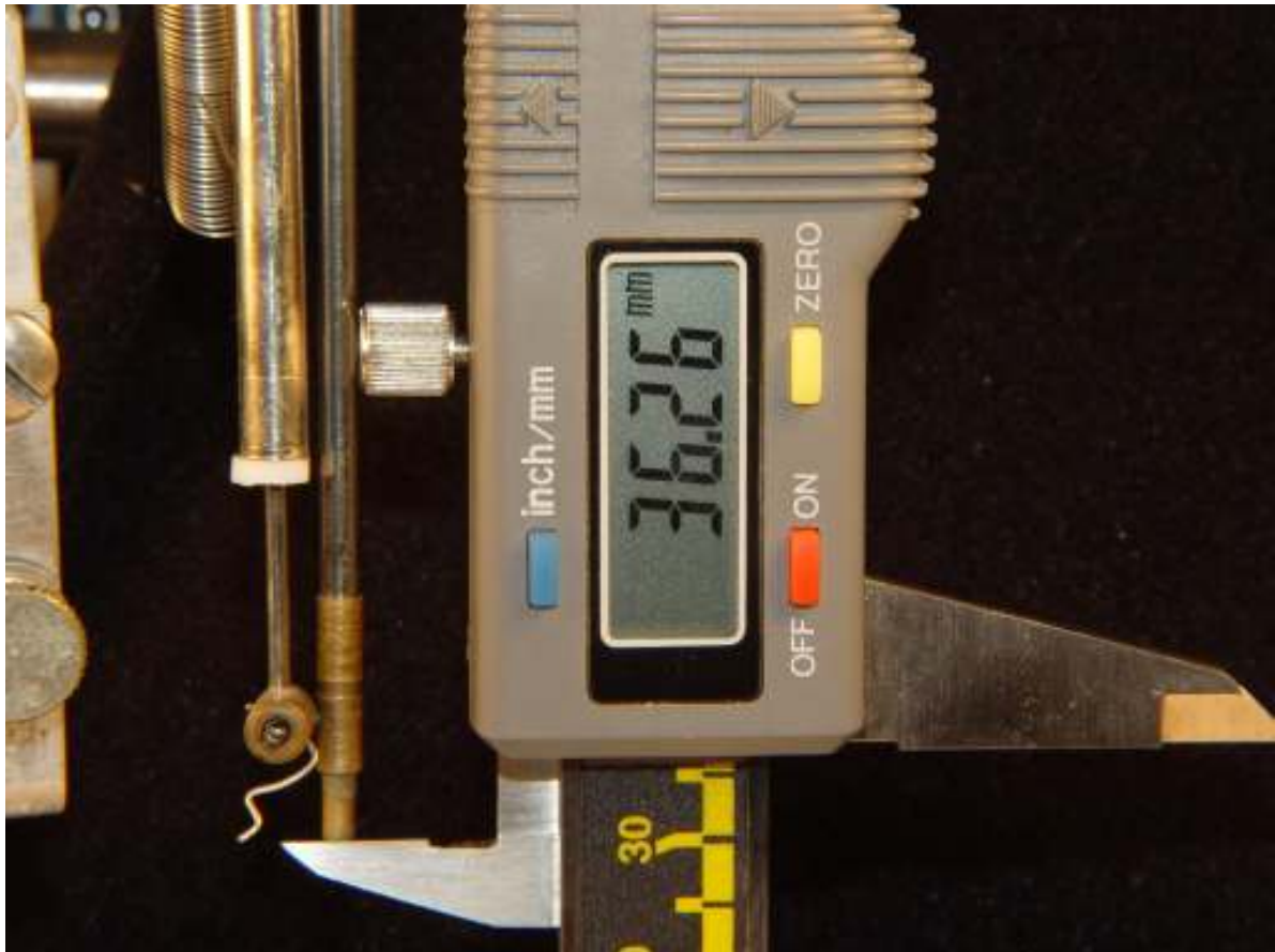
Figura 39 – Deslocamento da haste de contusão com auxílio do paquímetro
