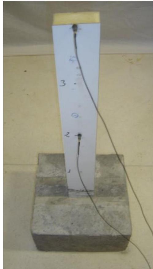
**FIGURA 6.3** Vista frontal da viga *sandwich* engastada na base de concreto
