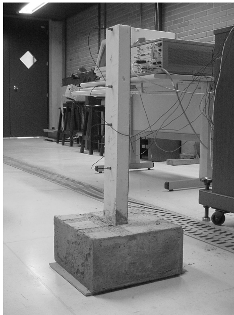
Figura 7.14 Engaste produzido no corpo de prova por meio de forma de concreto
