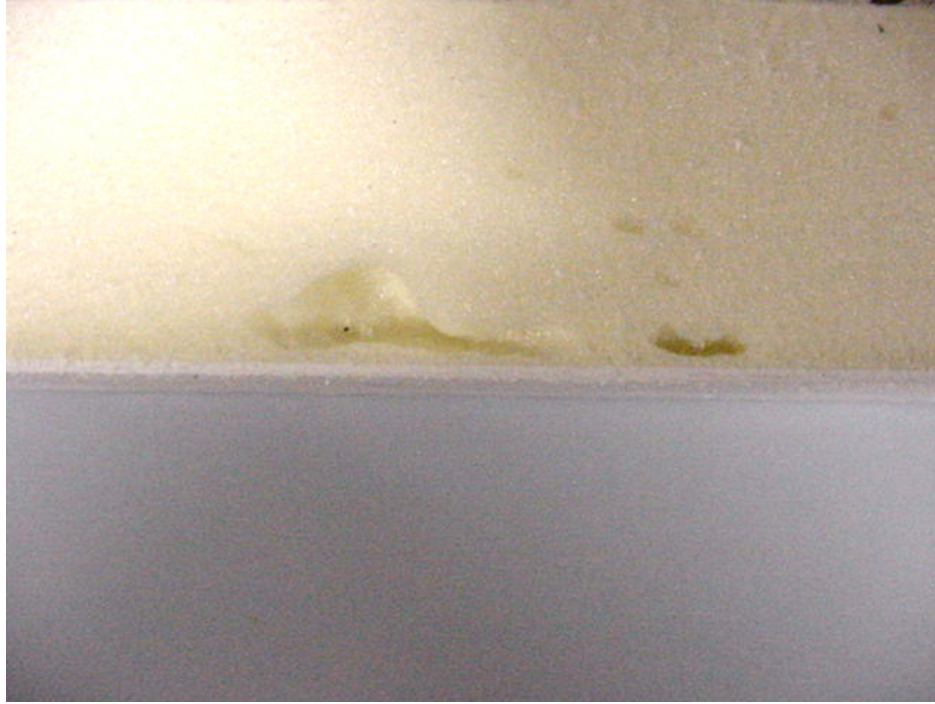
Figura 6.7 Descontinuidade encontrada na interface entre a lâmina de Poliestireno e a espuma
