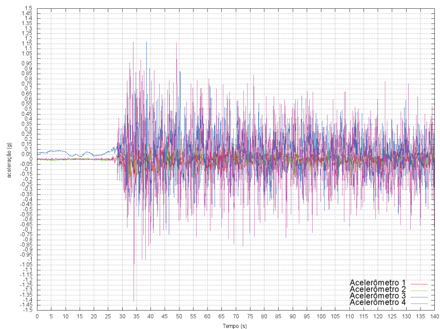
Figura 5.29 – Dados de aceleração no domínio do tempo para o ensaio transiente para amostra com defeito tipo corrosão interna (fonte: O autor, 2015).
