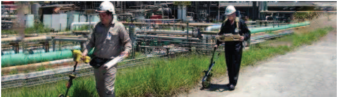
Figura 2.9 – Inspeção de dutos pelo método de Memória Magnética (fonte: MORKEN, 2015).
