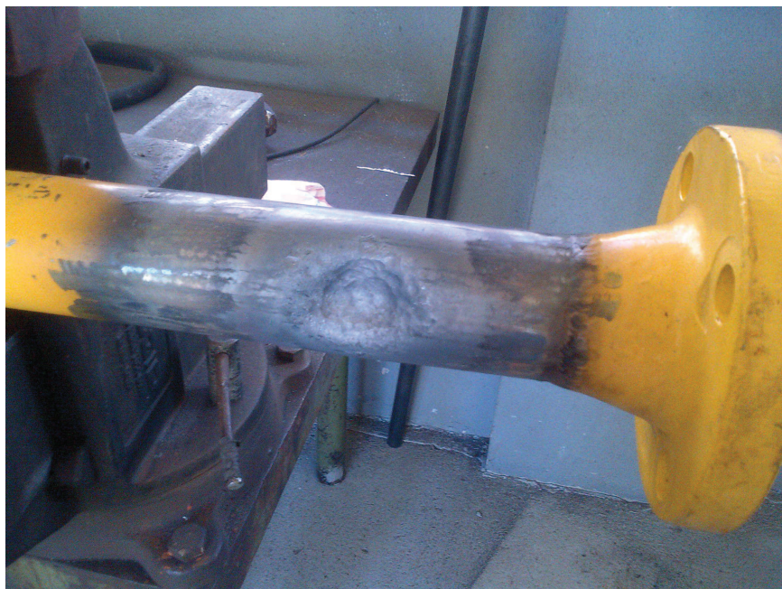
Figura 5.9 – Detalhe do defeito tipo mocha introduzido na segunda amostra (fonte: O Autor, 2015).
