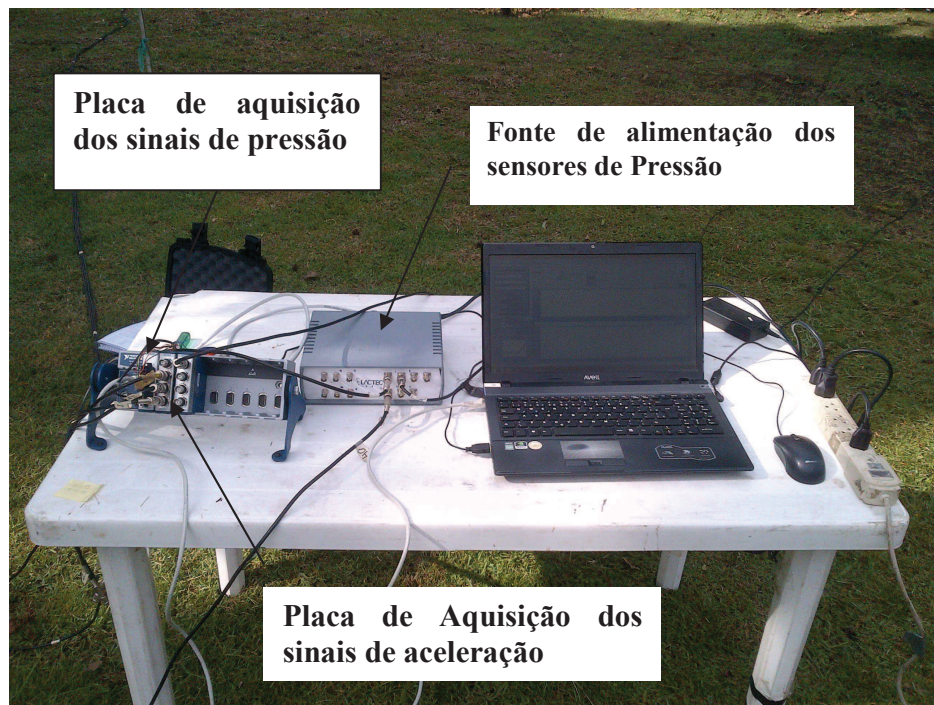
Figura 5.12 – Sistema de aquisição da National Instruments utilizado nos ensaios (fonte: O Autor, 2015).
