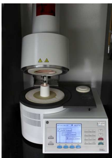
Fig 11: Posicionamento do êmbolo sobre as pastilhas
