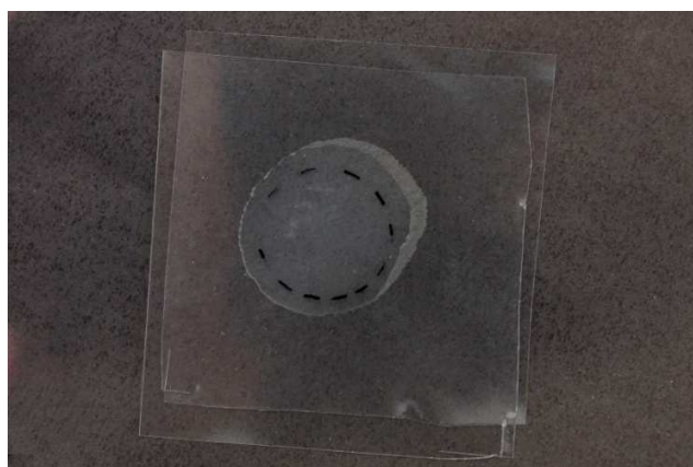
Fig 28: Área do disco cerâmico demarcada sobre a lâmina de acetato
