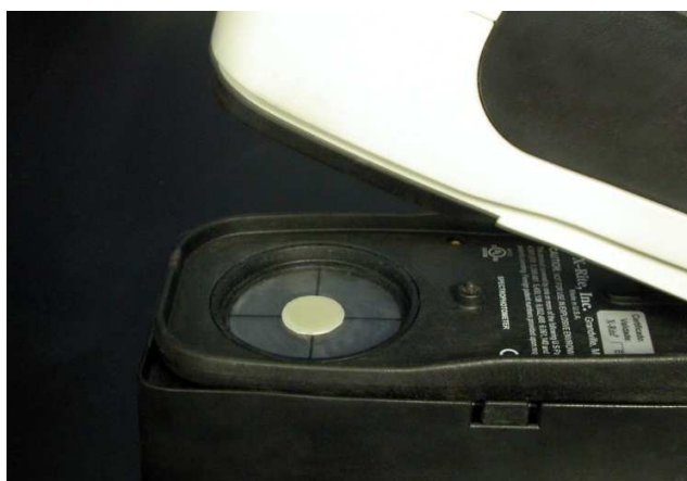
Fig 8: Espécime posicionado no slit para leitura de cor
