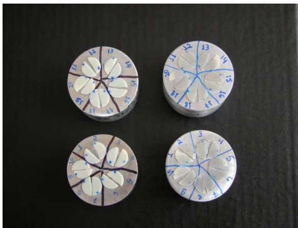
Fig 7: Espécimes posicionados em bases de alumínio previamente ao teste de nanoindentação
