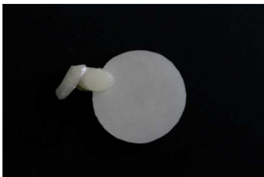
Fig 21: Vista de um disco cerâmica após corte do sprue
