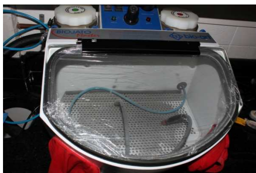
Fig 17: Jato de óxido de alumínio
