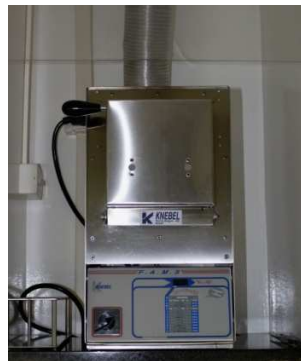
Fig 6: Forno para evaporação da cera
