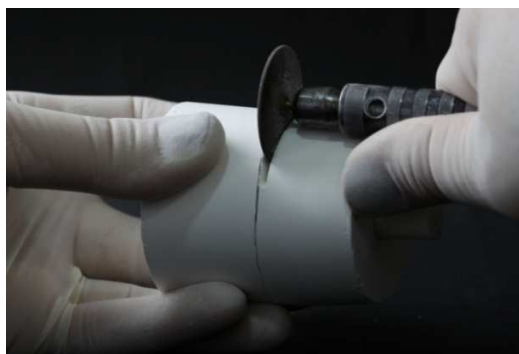
Fig 14: corte do revestimento com disco de carborundum
