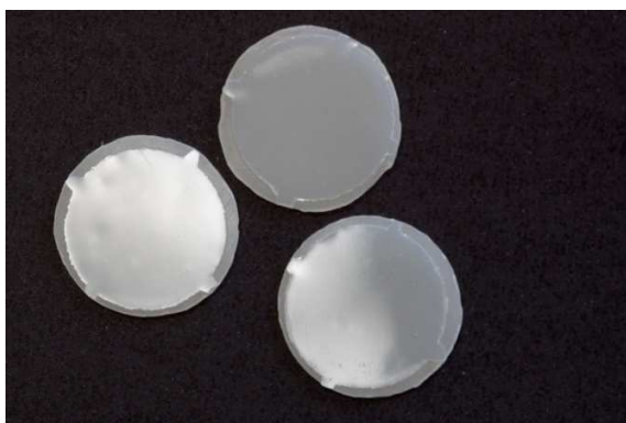
Fig 5: espécimes de Empress com o cimento aderido
