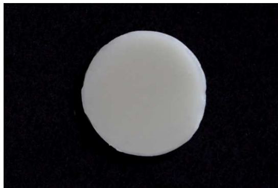
Fig 22: Disco cerâmico após acabamento
