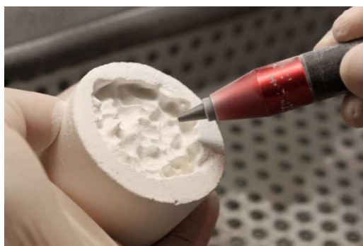
Fig 18: Eliminação grosseira do revestimento com pressão de 4 bar
