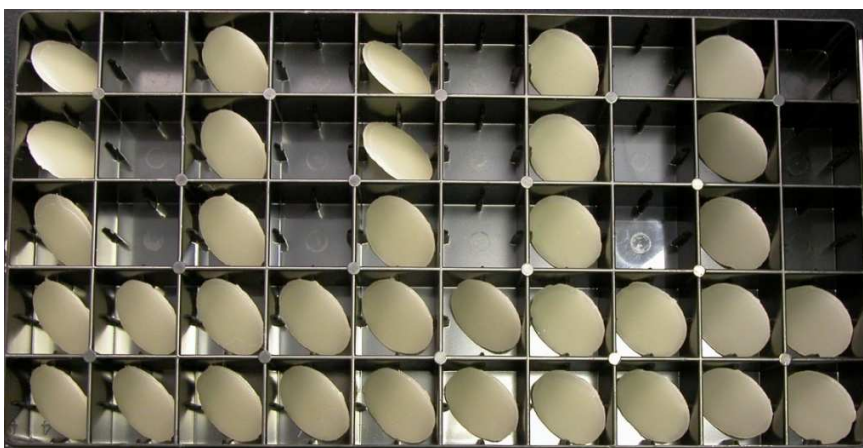
Fig 6: Espécimes de cerâmica e material cimentante separados por grupos em recipiente escuro
