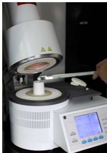
Fig 8- Colocação da pastilha no revestimento em forno pré-aquecido
