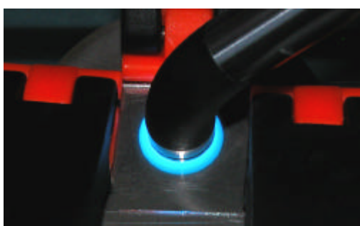
Fig 5 – Fotopolimerização central do espécime de resina composta
