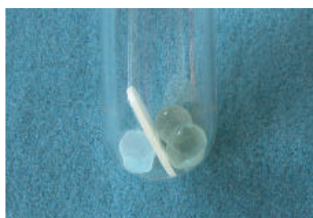
Fig 12: Espécime entre pérolas de vidro dentro do tubo de ensaio
