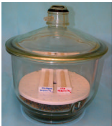
Fig 6: Dessecador contendo os discos e os discos de resina composta
