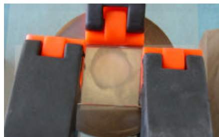
Fig 2: Extravasamento do material devido à pressão
