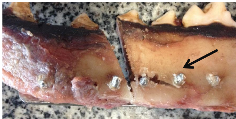
Figura 21 – A imagem indica o padrão de falha ocorrido no grupo 2. Ocorreu fratura do osso mandibular(seta) no fragmento caudal a linha de fratura
