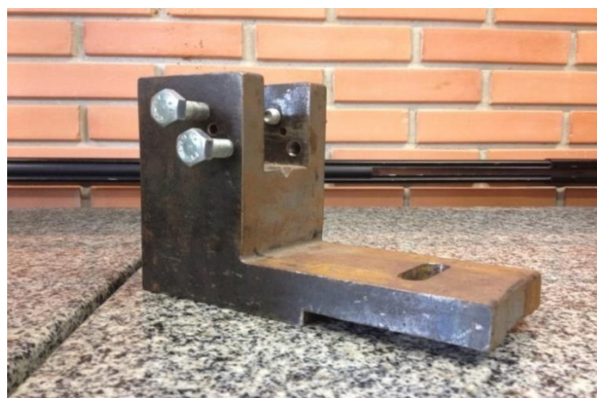
Figura 18 – Peça metálica desenvolvida para fixação das hemimandíbulas caninas.
