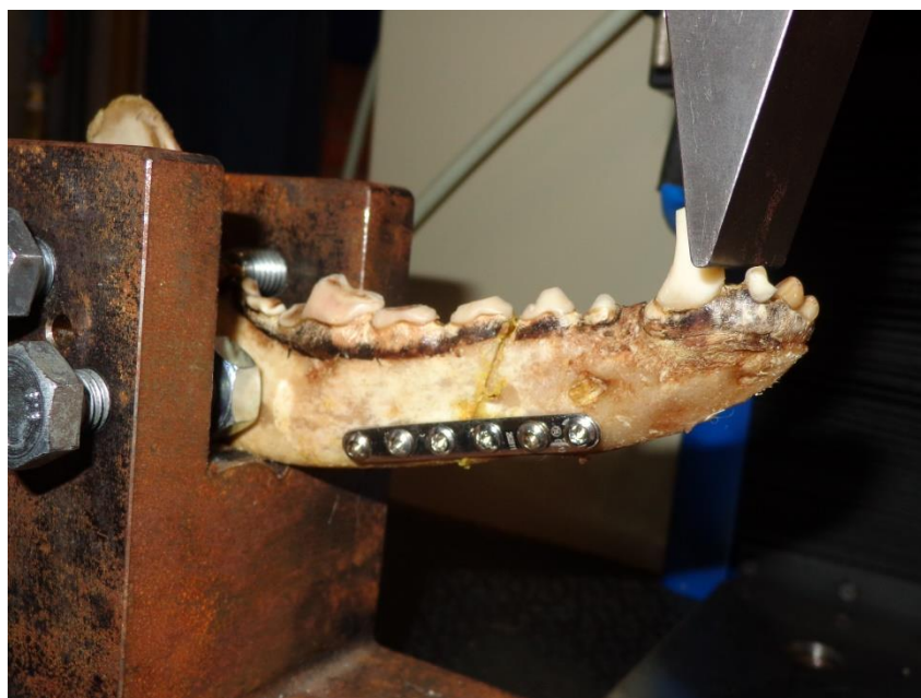
Figura 19 – Hemimandíbula de cão posicionada para o teste biomecânico. Nota-se a força sendo aplicada sobre os dentes incisivos.
