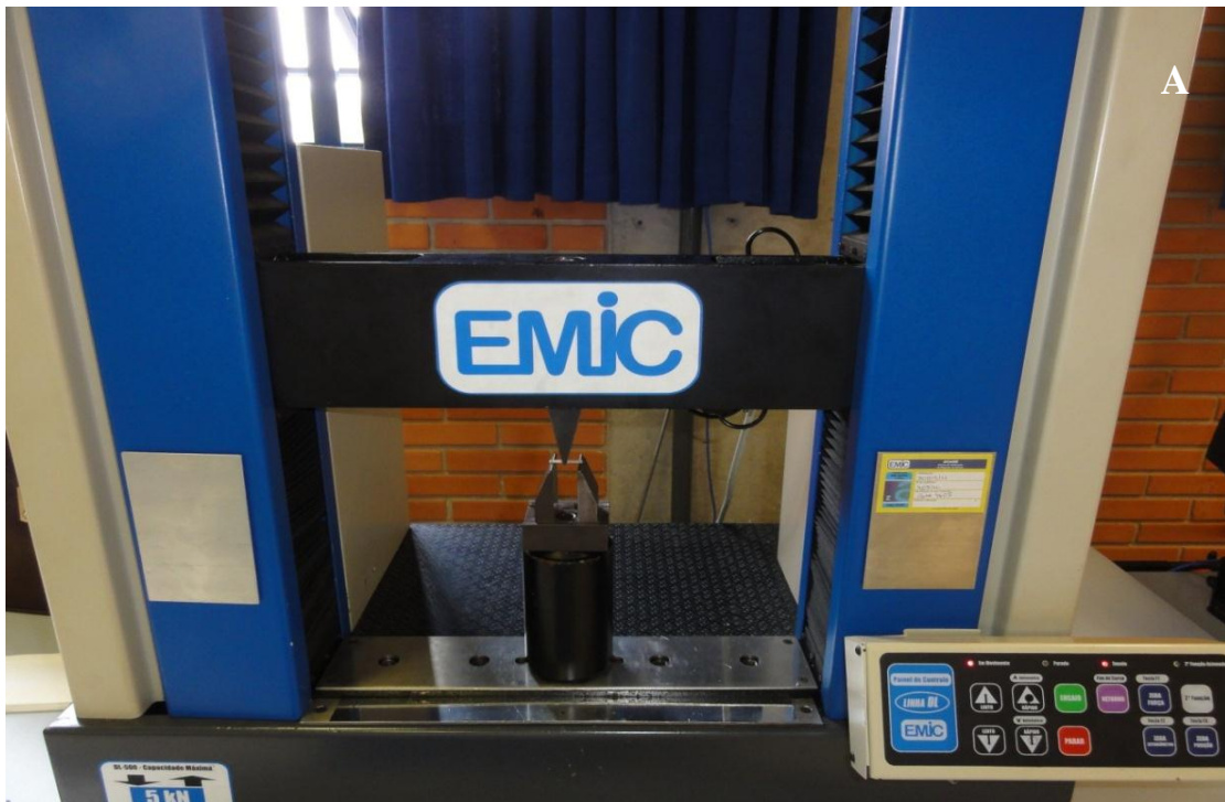
Figura 20 - Teste de flexão de três pontos na máquina para teste universal Emic (A, B)
