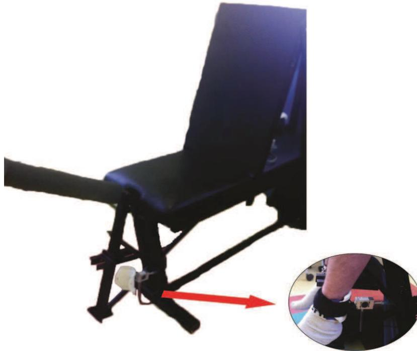
Figura 6 – A -Cadeira adaptada; B – Sensor de força
