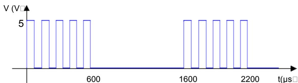
Figura 29 - Representação do trem de pulsos gerado pelo módulo emissor.
