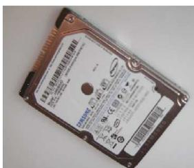
Figura 44 – Disco rígido de 2,5”, modelo HM080HC, marca Samsung.
