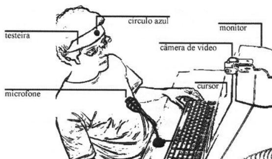
Figura 20 - Controle do Cursor do *Mouse* pelo Movimento da Cabeça Usando Câmera CCD e Processamento de Sinais (DIAS et al., 2004a)
