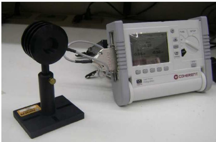
Figura 50 – Medidor de energia 3 Sigma Single – Chanel da Coherent e sensor PM10 da Power Max.
