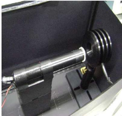
Figura 52 – Emissor de radiação infravermelha adaptado em tubo preto.
