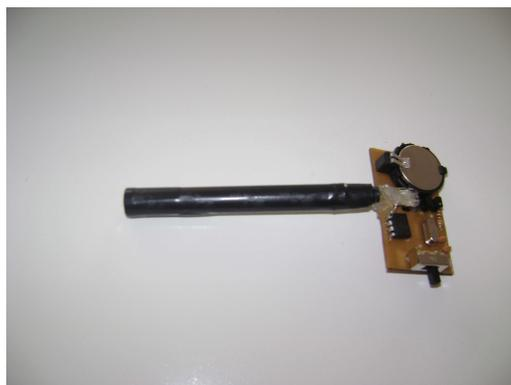
Figura 31 - Representação do módulo emissor do acionamento remoto do teclado especial.
