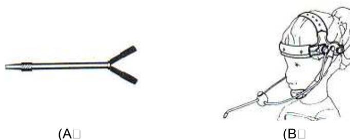
Figura 14 - Acionador de teclado. Em (A), ponteira e, em (B), ponteira adaptada à cabeça (COOK e HUSSEY, 2002).
