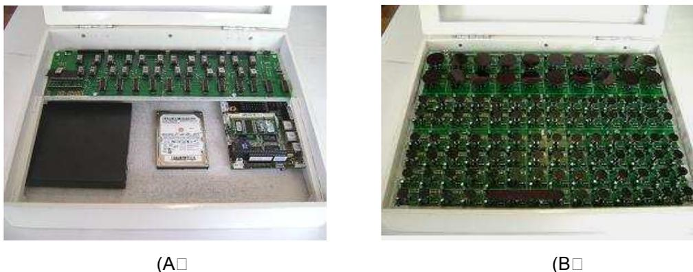
Figura 62 - Fotos do gabinete contendo placa controladora em (A) e teclado em (B).
