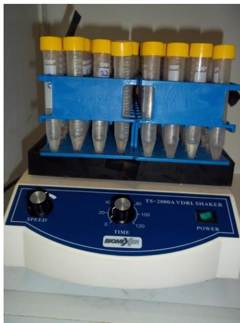
**Figura 4** – Suspensão das amostras no homogeneizador Biomixer, pelo período de 8 horas em pernoite, para remoção do alérgeno da poeira, ficando concentrado na solução. Fonte: O Autor, 2014.
