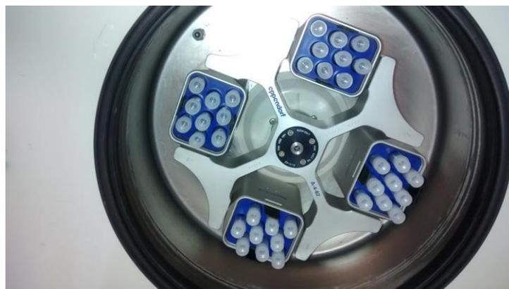
**Figura 15** – Centrifugação de 36 amostras, em 2500 rpm durante 20 minutos, na temperatura de 4°C, em uma centrífuga Eppendorf modelo 5810f. Fonte: O Autor, 2014.
