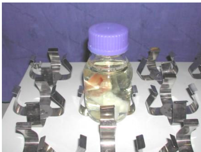
Figura 4 – Procedimento experimental de descélularização de valvas pulmonares porcinas. Na representação, frasco contendo valva pulmonar em SDS 0,1%, sob agitação constante.
