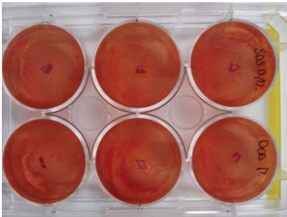
Figura 18 – Teste de citotoxicidade. Nos poços superiores foram adicionados fragmentos de conduto descelularizados com SDS 0,1% e nos poços inferiores, fragmentos descelularizados com DOA 1%.
