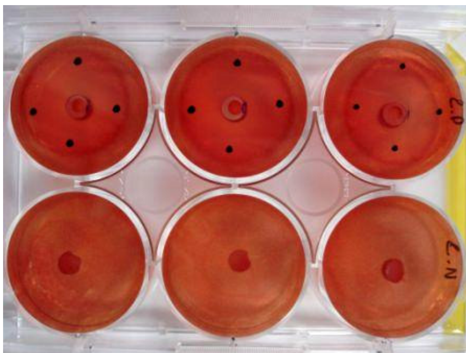
Figura 17 – Teste de citotoxicidade. Nos poços superiores foram utilizados fragmentos de 0,25\text{cm}^2 de PVC como controles positivos. Nos poços inferiores foram utilizados pedaços de papel de filtro estéril como controles negativos.
