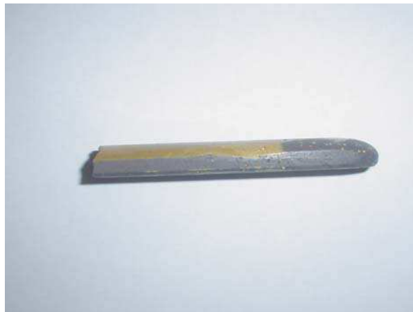
Figura 8 - Placa de Vitrocerâmico de Anortita. Este placa foi utilização na implantação in vivo. Fonte: A pesquisa
