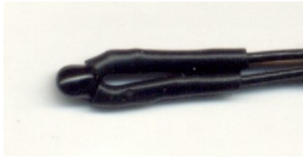
Figura 33 - Termistor com isolamento termo-contrátil
