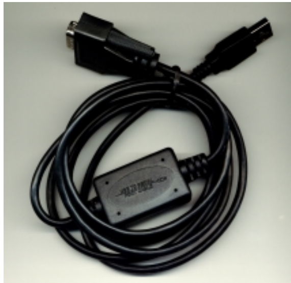
Figura 49 - Adaptador serial para porta USB
