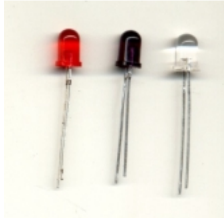
Figura 25 - LEDs Vermelho, Infravermelho e Receptor
