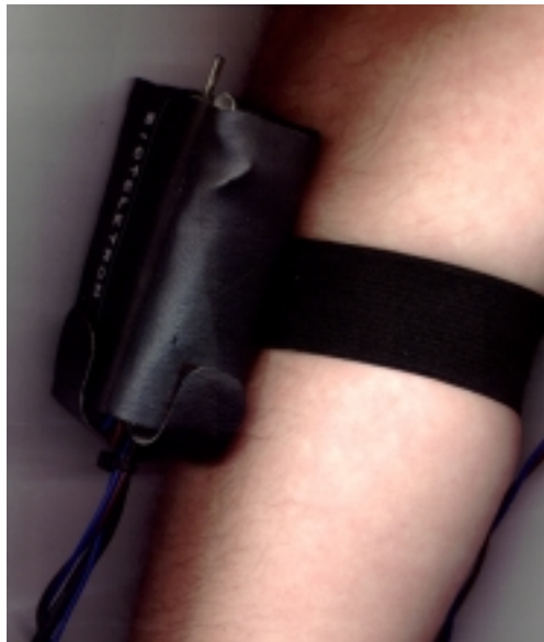
Figura 46 - Fixação do dispositivo de biotelemetria em um braço
