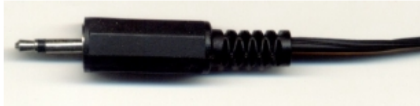
Figura 39 - Plug do sensor de podometria
